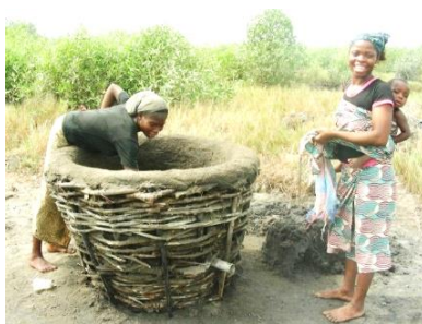
Photo 8 : Fabrication du panier de filtrat
