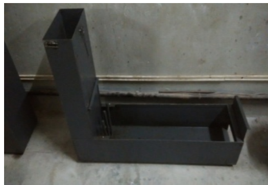
Fig. 6 L- box Apparatus
