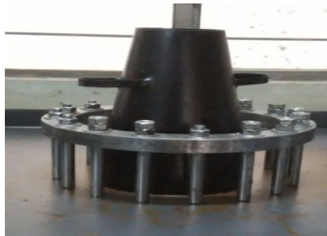
Fig. 3 J –ring Apparatus
