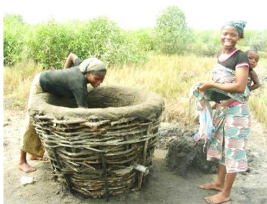
Photo 8 : Fabrication du panier de filtrat
