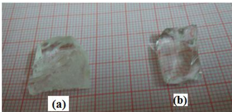
Fig. 2. Photograph of (a) undoped TTPC and (b) sodium sulfate doped TTPC crystals
